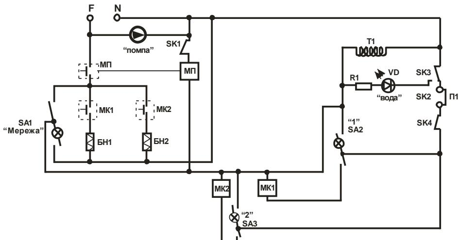
Рис.3 Схема електрична принципова КЕО-6/220-Н
