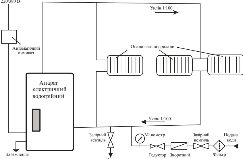
Рис.2 Принципова схема системи опалювання, що рекомендується
