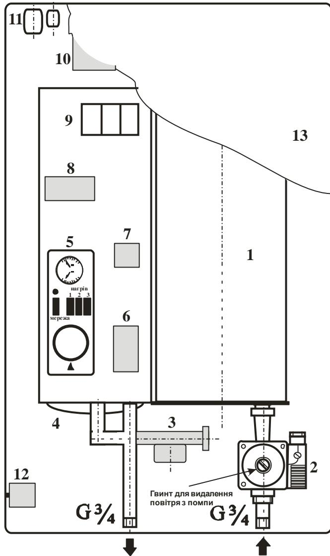
1-бак; 2- циркуляційна помпа; 3-запобіжний клапан; 4-розширювальний бак; 5- пульт управління; 6-плата затримки; 7- плата «с/х»; 8-пускач електромагнітний; 9-модульні контактори; 10-клемник; 11-ввідні втулки; 12-термообмежувач; 13-коужух.
